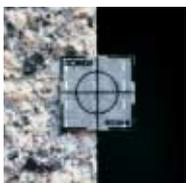
En los modos de prisma o lámina reflectante, la salida máxima de láser se reduce automáticamente a 0,22 mW. Es equivalente al nivel de un láser de Clase 1 IEC/FDA. La Serie 30RK incluye también un filtro de seguridad en el telescopio, que protege sus ojos del haz láser en el caso de que mire un prisma reflectante o una lámina reflectante en modo no reflectante.
