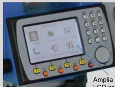
Amplia e iluminable pantalla LCD con indicador del nivel electrónico
