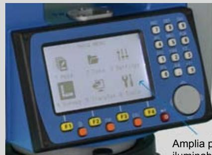
Amplia pantalla LCD iluminable con indicación del nivel electrónico
