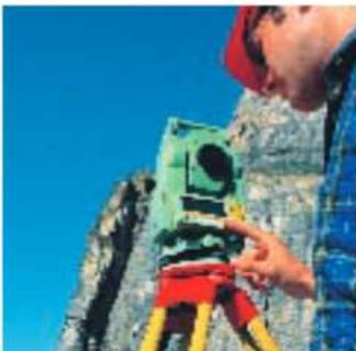
*¿Ha pensado alguna vez cuánto tiempo pierde con la puntería manual a los puntos de medición? Con ATR, el reconocimiento automático del prisma, podrá medir el doble de puntos en el mismo tiempo.*
