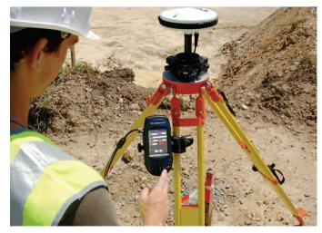
Nunca ha sido tan fácil encontrar y realizar levantamientos de puntos de difícil acceso, con la funcionalidad de navegación y de toma de datos de ProMark3. Tras navegar hasta un punto, utilizando el mapa base de la unidad, pasar al modo de levantamiento sólo requiere un único toque de teclado.
