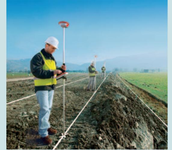
Replanteo con respecto a una alineación 3D utilizando la opción Avance. Los puntos pueden ser replanteados usando cualquier valor de distancia y desplazamiento. Trabaja con cualquier combinación de elementos geométricos.
